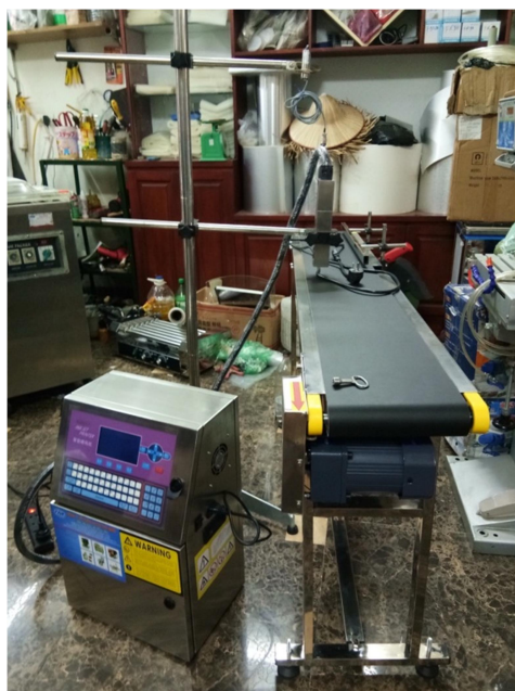
Máy kết hợp với băng tải, giá đỡ
