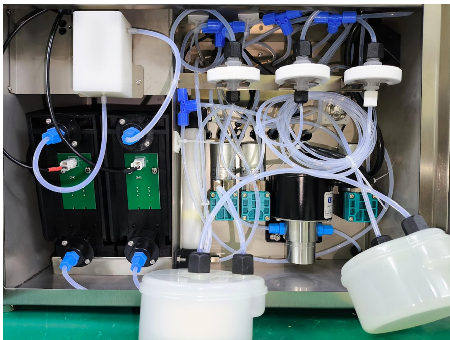
Hệ thống ống phun mực, và pha mực nhìn từ phía sau
